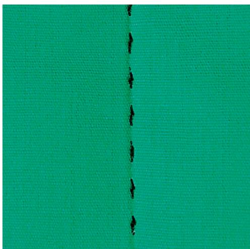
El quilting es adecuado para todos los tejidos y proyectos de costura que tengan que parecer cosidos a mano. Se recomienda utilizar hilo monofilamento para el hilo superior e hilo de bordar para el hilo inferior. La velocidad debe ser baja para evitar que el monofilamento se rompa. Si fuera necesario, es posible adaptar la tensión del hilo superior y el balance al proyecto de costura y al quilting deseado.
