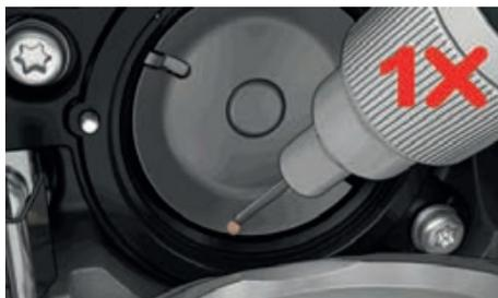
> Poner una gota de aceite para máquinas de coser BERNINA en cada uno de los dos depósitos de aceite hasta que los fieltros estén húmedos y asegurarse de que la superficie de la lanzadera marcada en rojo esté libre de aceite.
