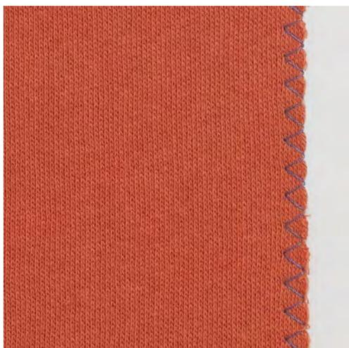
Le Point de zigzag n° 2 convient pour tous les tissus. Il peut aussi être utilisé pour des coutures élastiques et des travaux décoratifs. Utiliser un fil fin de reprise pour les tissus fins. Pour la couture chenille, il est recommandé de régler un zigzag court dense d'une longueur de 0,3 à 0,7 mm. La couture chenille peut être utilisée pour les appliqués et pour la broderie.
