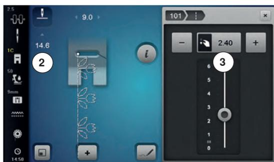
En las otras muestras de punto, alfabetos inclusive, está indicado el largo total de una muestra de punto **2**. El largo efectivo del punto **3** está solo visible con el display abierto del largo del punto.
