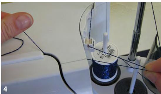
A causa de la mayor resistencia en el desenrollamiento radial del hilo, hay que devanar en el enhebrado hilo adicional de la canilla. Esta reserva de hilo garantiza que el enhebrado automático se efectúe correctamente (ilustración 4).
