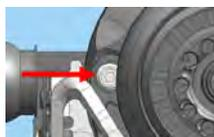
Después de lubricar, poner la lanzadera en la posición ilustrada (véase ilustración izquierda) girando el volante a mano en el sentido de las agujas del reloj para poder enhebrar correctamente.
