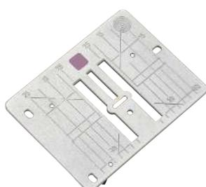
Cette plaque à aiguille a un marquage violet et un trou réduit de 5,5 mm. Elle convient à toutes les machines d'une largeur de point de 9 mm. Elle excelle dans la couture de tissus fins et souples. Elle permet de réaliser des travaux de couture riches en détails à l'aide de points zigzag et décoratifs d'une largeur maximale de 5,5 mm.
